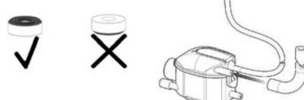
– Установить вытяжную трубу на крышку детектора по направлению вверх.
