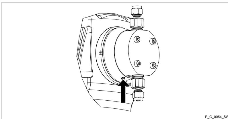
Fig. 37: Leakage hole
