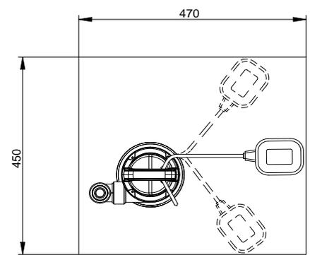
Fig. 7 Min. Size Of Sump
